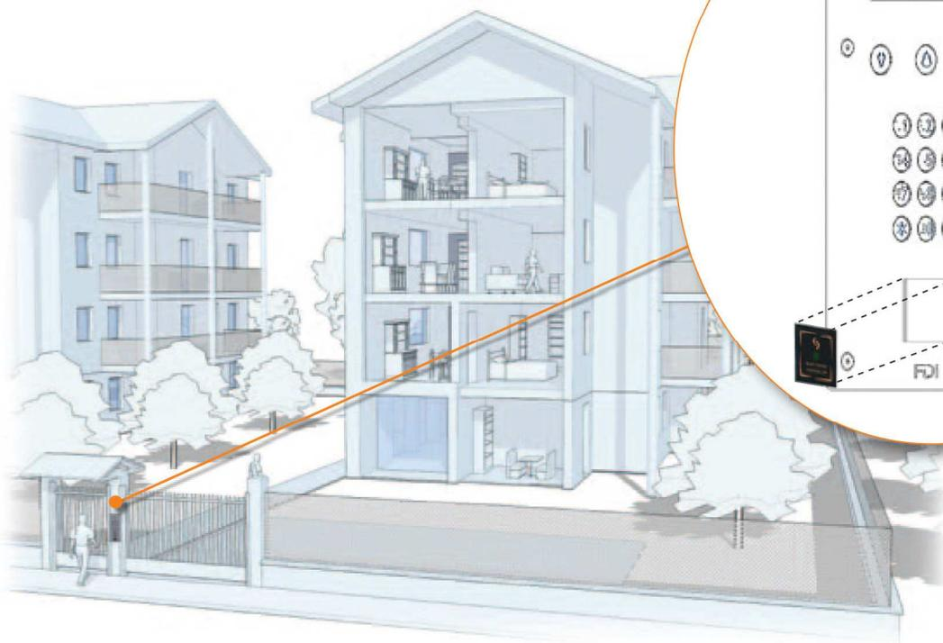
Se širokou paletou čteček, připojenou ke kontroléru pouze pomocí dvou vodičů, se může Easy Door Controller stát nenápadnou součástí i vaší budovy.
